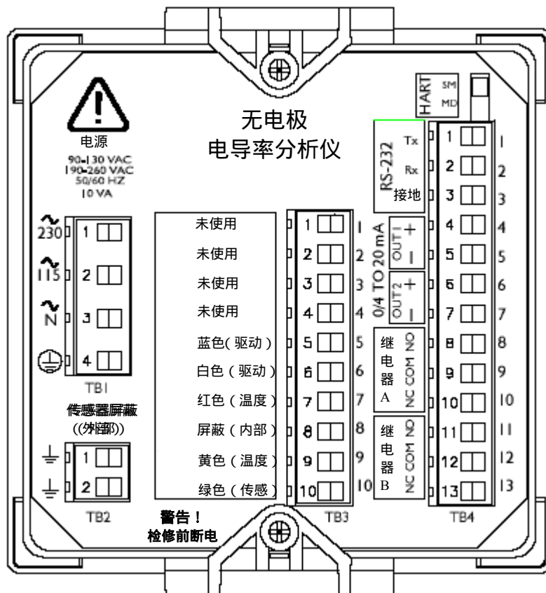
图 2-3 带字母“A”前缀序列号的分析仪接线端子指示 (HART 开关仅用于有 HART 选项时)
